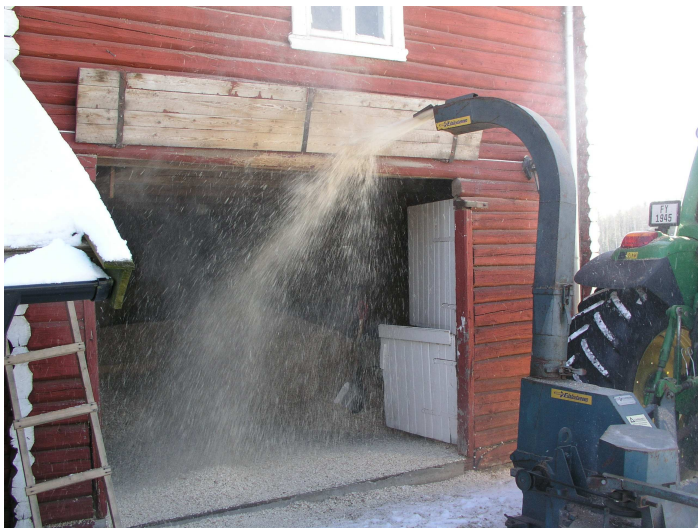
Flising på gardsvarmeanlegg i Elverum (2004)
