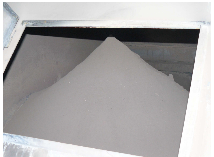
Riktig forbrenning gir bare synlig vanndamp og godt utbrent og grå aske!
