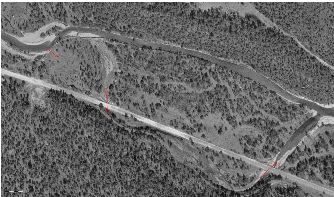
Figur 24. Ortofotogram med tydelig avtrykk av det gamle elveløpet fra 1977. Røde piler markerer sannsynlige flomretninger ved oversvømmelse (Norgebilder.no)
