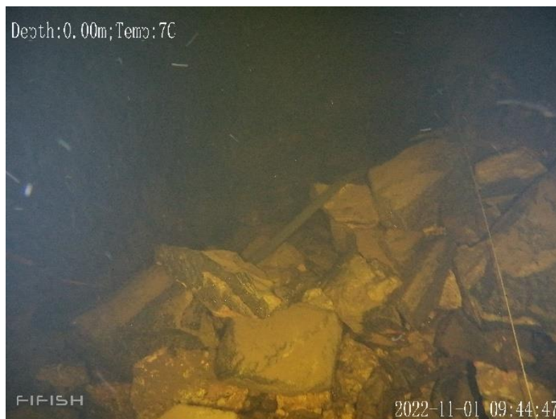
Figur 76: Bilde med undervannsdronne utenfor Horn. Substratet er i hovedsak svært grov stein/ blokk, trolig rester av sprengt berg.
