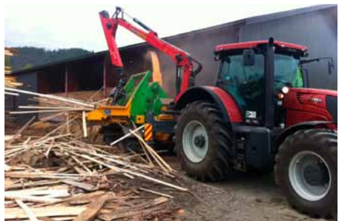
Flising av rivningsvirke. Kilde: Bioland AS.
